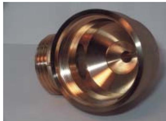
■ Корпус клапана с профилированной поверхностью
